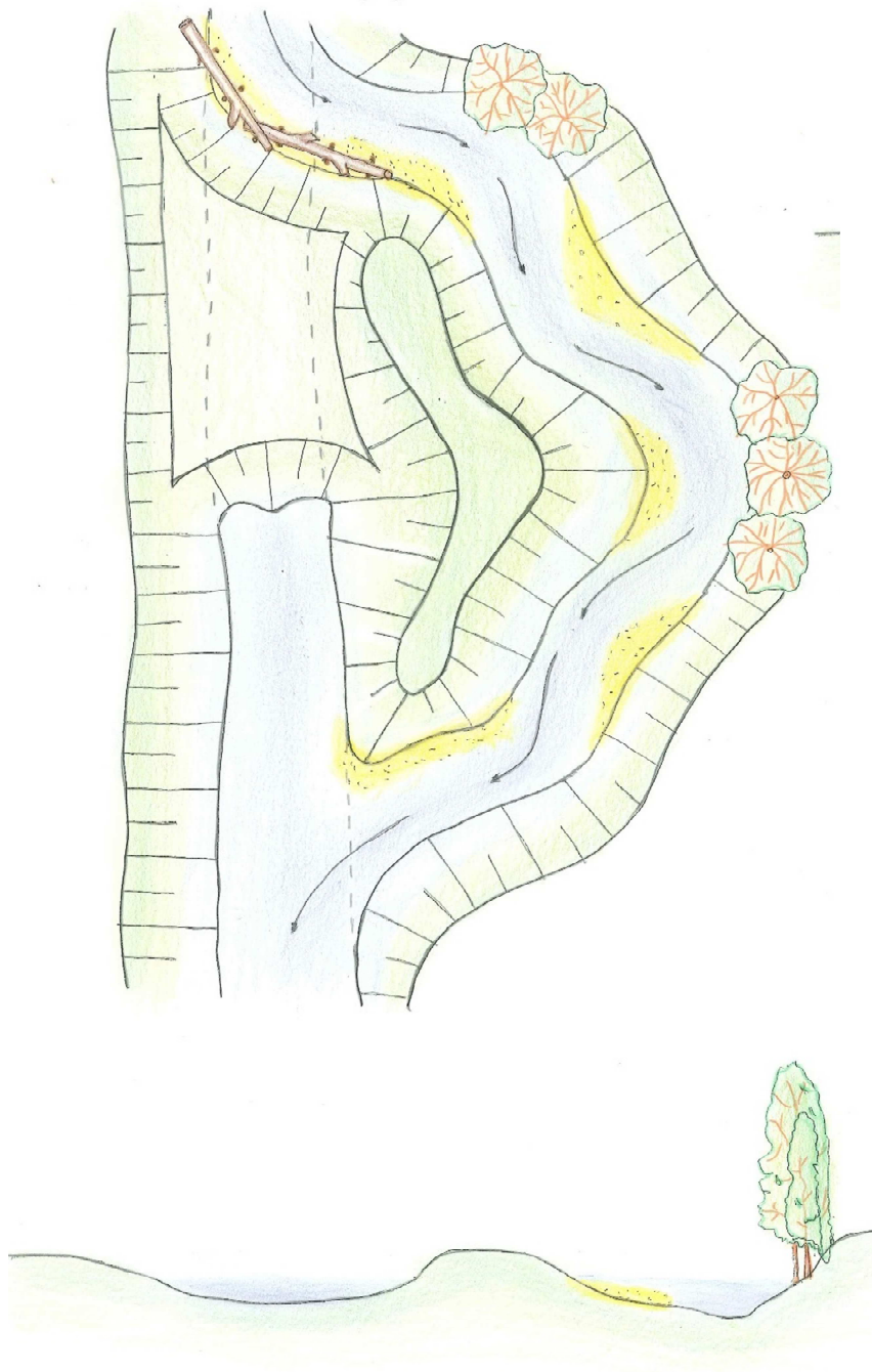
Abbildung 73: Laufverlegung mit Kieseinbau
