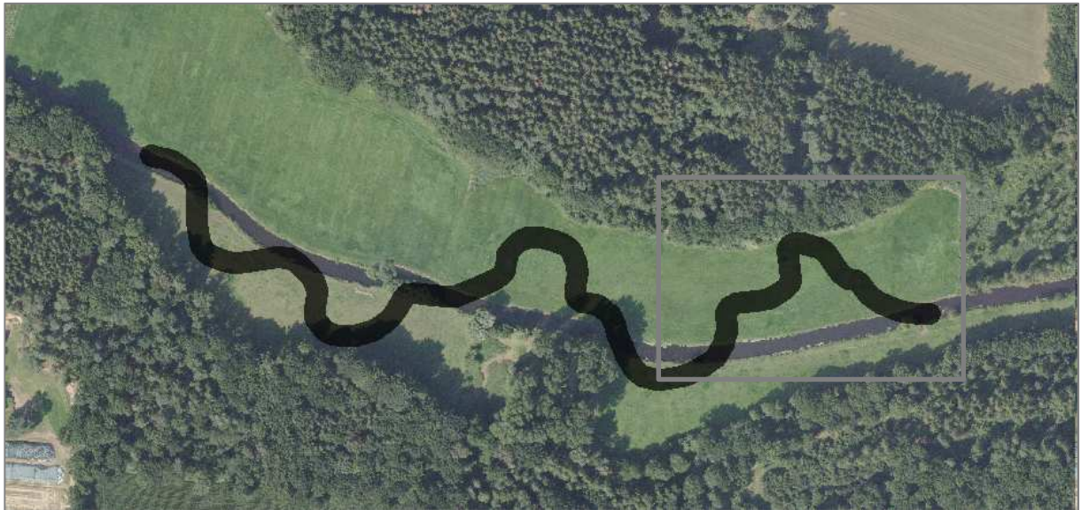
Abbildung 74: Beispielhafter Verlauf abschnittsweise Mäandrieren des Gewässerverlaufs der Bramau
